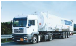
국산 탄소복합재(CFRP)를 적용한 수소 운송용 용기
